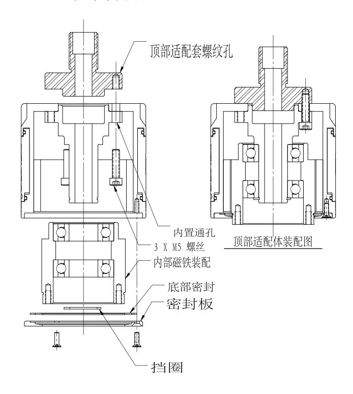
选项B如不欲工件顶部的螺丝外露,采用本选项。内部磁铁装置及密封分别邮寄装配。得到上顶部适配器后,须安装磁铁装置 密封。
