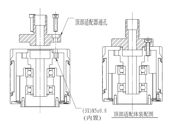
选项A:将主体邮寄装配。顶部适配器从顶部用三颗M5螺丝加固。
